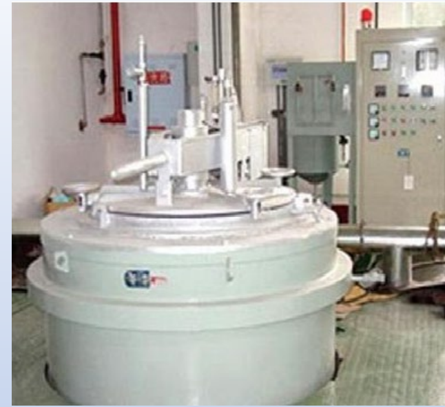
Lò thấm Các bon (Carbon absorber furnace)
