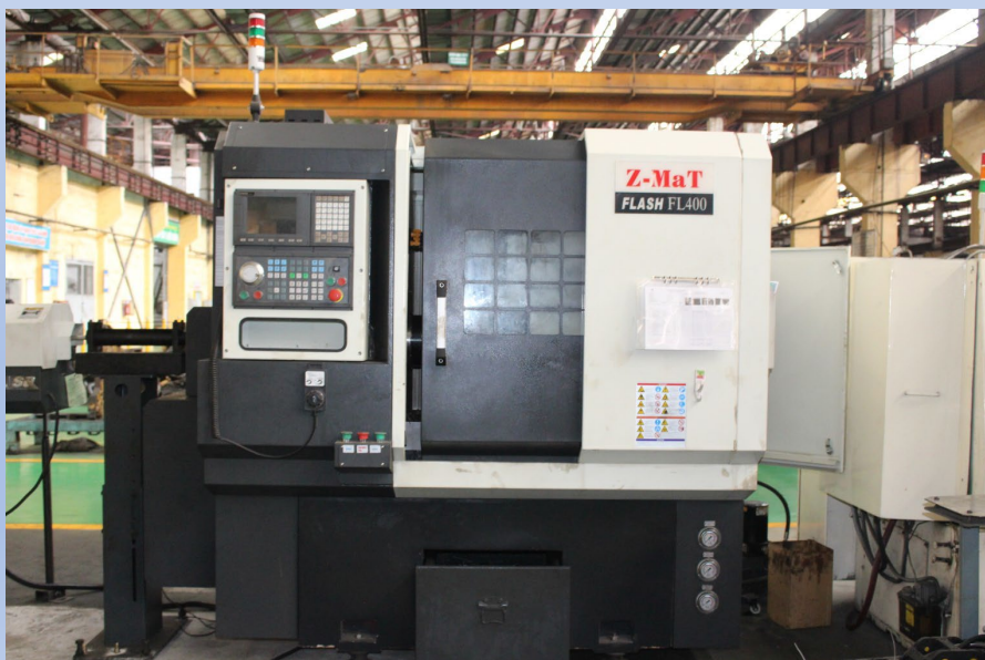
Máy tiện CNC cấp phôi tự động Automatic billet feeding CNC Lathe Machine
