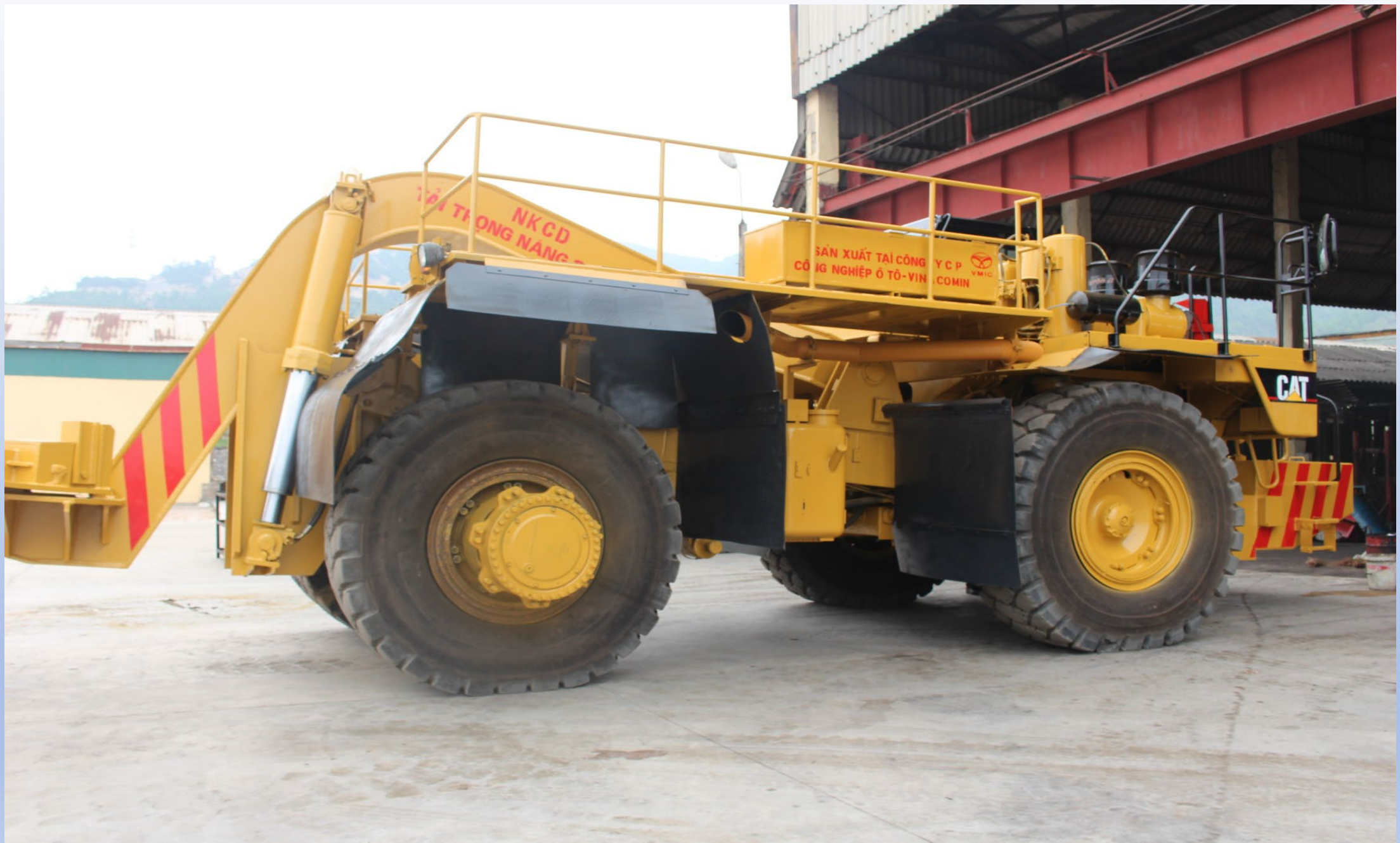
Cải hoán, thiết kế chế tạo xe nâng kéo
