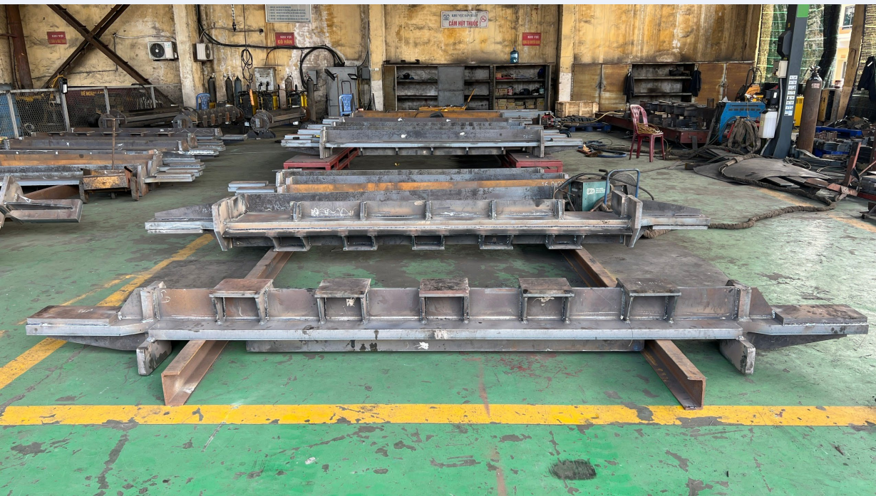
Sản phẩm chế tạo Máng Feender panes Na Uy Norwegian Feender panes manufacturing products
